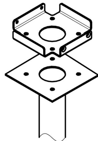
1. Фланцевую пластину установить на закладную деталь. Размеры монтажных отверстий см. рис. 1
