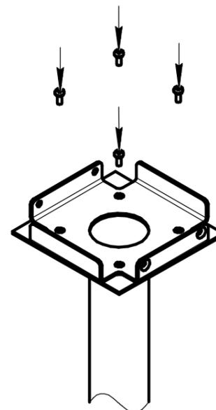
2. Зафиксировать комплектом метизов. Размер монтажных отверстий на фланце светильника см. страница 2.
